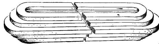
Рис. 1.5. Обмотка возбуждения полюса из плоских катушек
